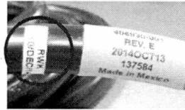
Рис. 2. Правильно собранный кабель питания (изготовлен в указанный промежуток времени, но имеет маркировку RWK)
